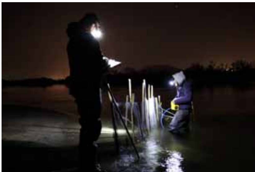
Figura 14. Mesures de velocitat de l'aigua, fondària de la columna i paràmetres ambientals durant les pesques nocturnes en la posició de cada bussó.
