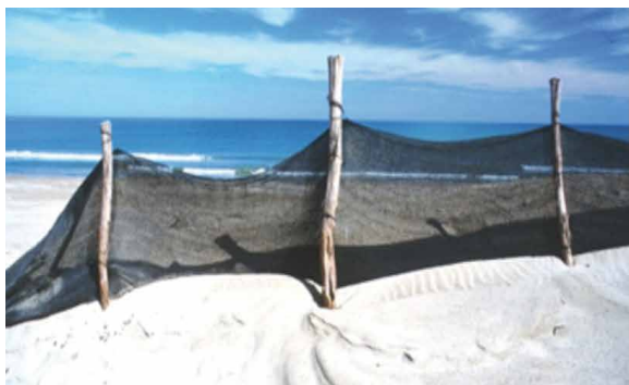
Fotos 8 y 9. Ensayos con distintos tipos de material y disposición para la fijación de la arena. Izquierda: Mallas de plástico. Derecha: Haces de ramaje de eucaliptos procedentes de la eliminación de estos árboles.
