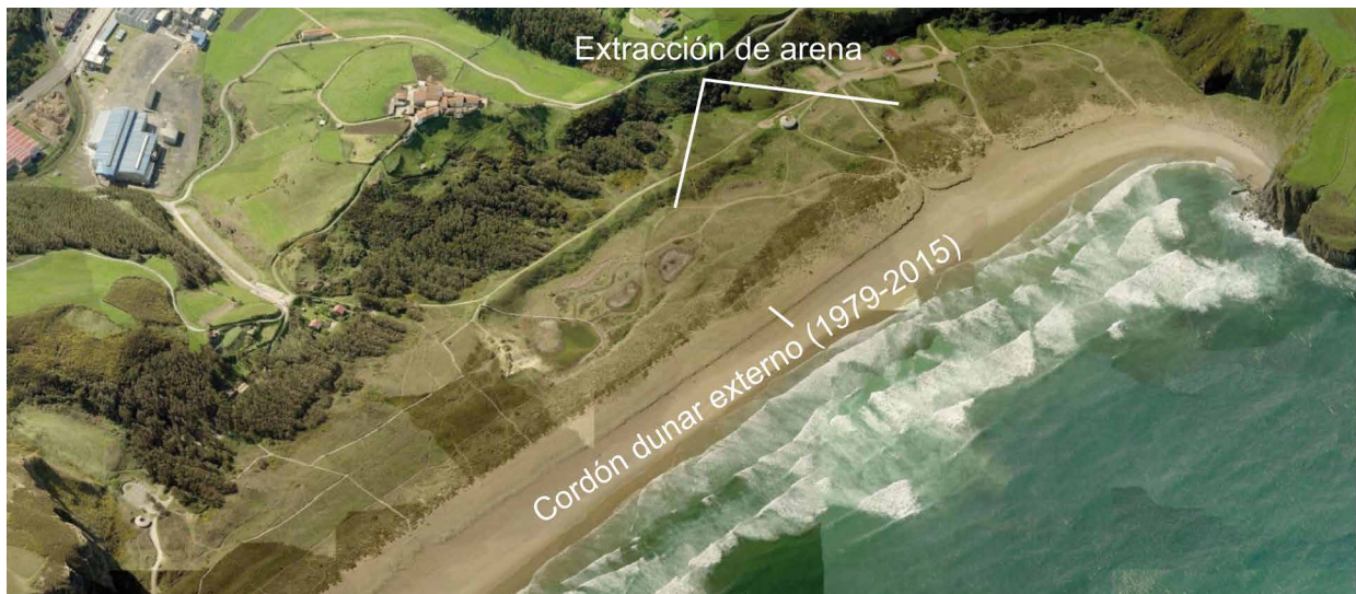
Figura 5. Aspecto del campo dunar de Xagó (Bing Maps 3D, 2014). Gran parte del campo dunar intermedio fue desmantelado para la minería extractiva de arena. Los continuos dragados en el estuario de Avilés, situado al oeste, y su posterior vertido en la playa sumergida de Xagó, han favorecido la formación de un cordón dunar desde 1979 con anchuras máximas de 60 m.
