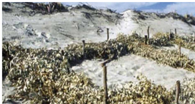
Fotos 8 y 9. Ensayos con distintos tipos de material y disposición para la fijación de la arena. Izquierda: Mallas de plástico. Derecha: Haces de ramaje de eucaliptos procedentes de la eliminación de estos árboles.
