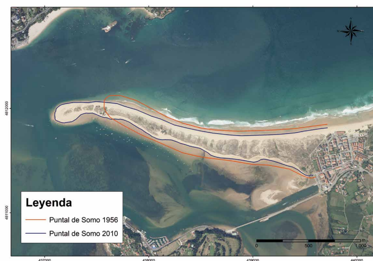
Figura 11. Evolución histórica de El Puntal de Somo desde 1956 hasta 2010, siguiendo los contornos de la parte alta intermareal y teniendo como referencia la planta de la flecha arenosa en cada fotograma.
